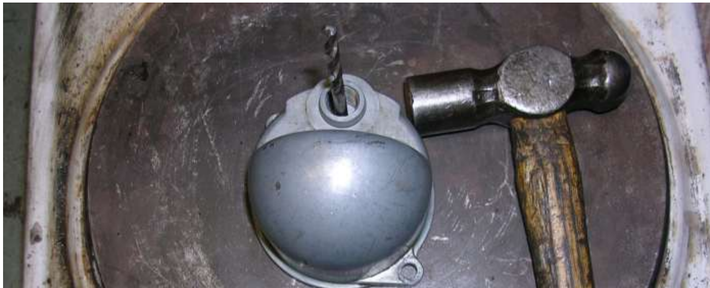
Sænkning af svømmerstand med et passende bor og en "sving presser"
